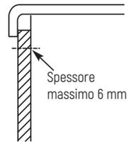
Lorsque vous installez des panneaux ayant moins de 6 mm d'épaisseur il faut prévoir un panneau de remplissage. L'épaisseur totale du panneau décoratif et du panneau de remplissage doit être de 6 mm.
