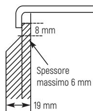
Il y a la possibilité d'utiliser des panneaux d'un épaisseur max de 19 mm. Le panneau doit offrir un dégagement pour les doigts d'au moins 5,1 cm du côté de la poignée afin de garantir l'ouverture de la porte. Il faut que les 8 mm externes du périmètre du panneau ne soient pas plus épais que 6 mm.
